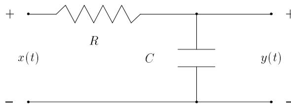
Figura 5: Circuito RC con tensione di ingresso  $x(t)$  e tensione di uscita  $y(t)$ .
