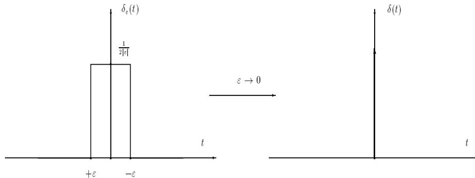
Figura 3: Procedimento di costruzione di un impulso  $\delta(t)$  tramite la funzione  $\delta_\varepsilon(t)$ .
