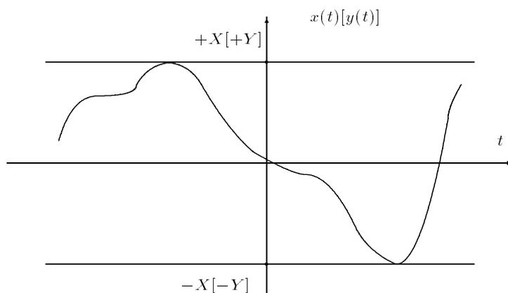
Figura 8: 'Fascia' orizzontale, simmetrica intorno all'origine, che delimita i segnali di ingresso [di uscita] in un sistema stabile BIBO.
