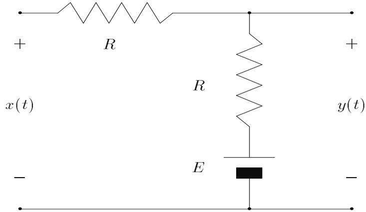
Figura 6: Esempio di circuito non lineare.
